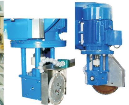
Brückenmaschine mit verfahrbarem Tisch zum Fräsen und Schleifen von Winkelstufen, Tritt- und Setzstufen, Fensterbänken, Türrahmen, Podesten und anderen linearen Elementen aus Beton.
